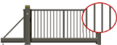
Profil 3030 Quadratrohr 30x30 mm aus Aluminium, senkrecht & mittig im Rahmen, Stababstand ca. 100 - 120 mm
